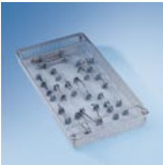
E 142 Complemento 1/2 • Jaula de malla metálica normalizada DIN • Malla metálica 1 mm • Abertura de malla: 5 mm • Marco perimetral: 5 mm • 2 Asas de transporte abatibles • Capacidad de carga máxima 10 kg
